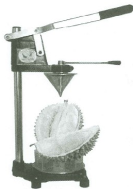
Mesin pembuka durian Durian peeling machine
